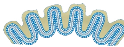
Cartuccia con elevato deposito
